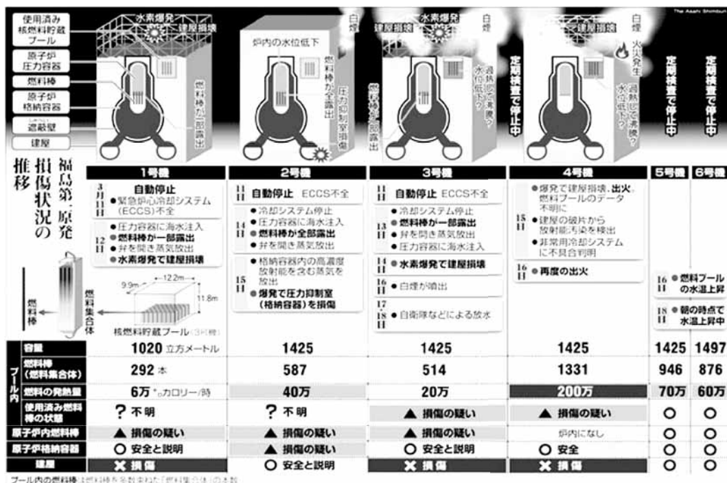
図1 福島第1原発1～4号機の原子炉建屋の爆発損傷 (1号機と3号機は水素爆発, 2号機と4号機の爆発損傷の原因は5月24日段階で今も不明だが, 水素爆発ではないかと思われる。) [ネットより引用]
